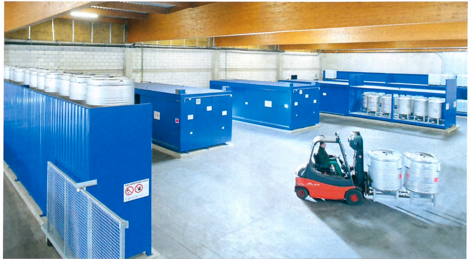
➊ Auf Kundenwunsch werden die Regalcontainer so gebaut, dass sie sich einfach per Gabelstapler beladen lassen.
